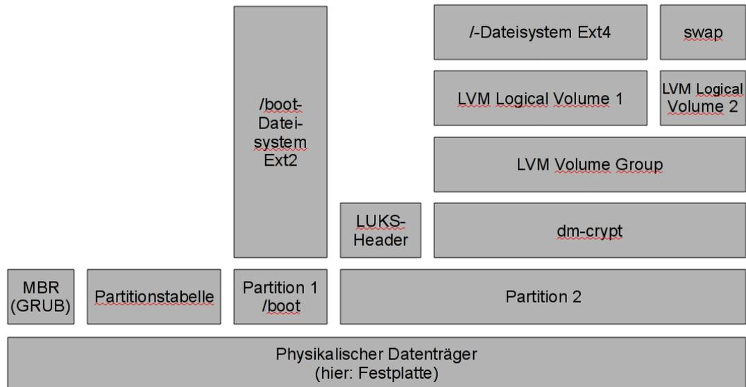
Abbildung 3.1: Die Verteilung der unterschiedlichen Container im Datenträger
